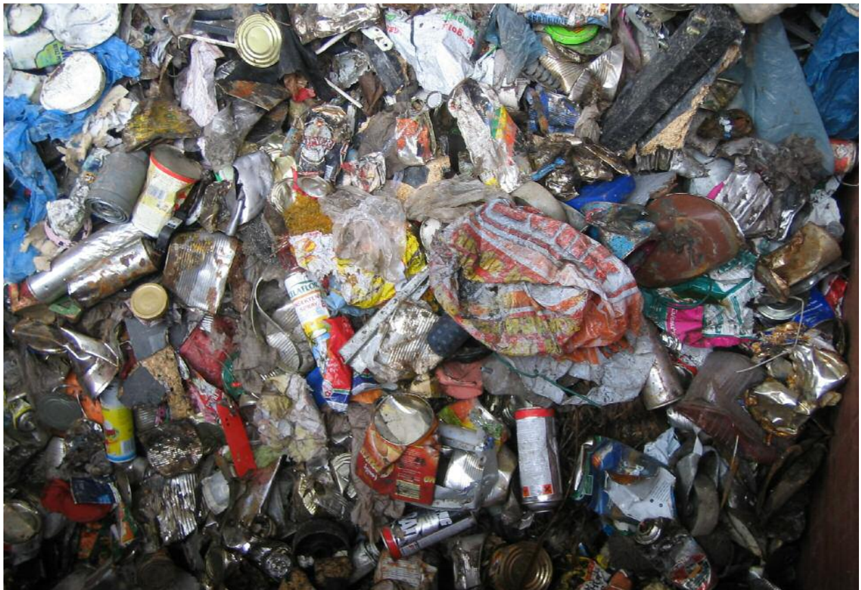
Abbildung 3 Aus der heizwertreichen Fraktion gewonnener Schrott Scrap obtained from the fraction of high calorific value
